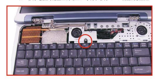
4. 松开所有的散热器中的螺丝。
